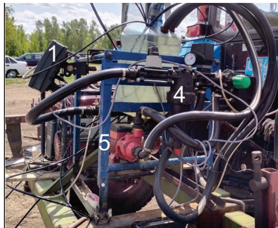
1. Борттық компьютер. 2. Тереңқопсытқыш рамасы. 3. Жұмыс органы. 4. Сұйықтық таратқыш жиынтық. 5. Сорғы. 6. Генератор.
