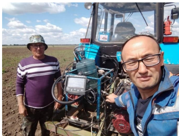
Ғ. 5-сурет. Эксперименталдық тереңқопсытқыш (а) СМТ-ны беру және тарату қондырғысы орнатылған күйі (ә)
