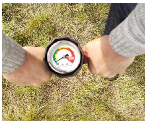
а – қажетті тереңдікті өлшеу және оның профилі; ә, б – топырақтың тығыздығын өлшеу; в – топырақтың ылғалдылығы мен температурасын өлшеу
