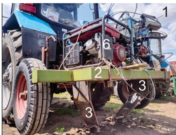
1. Борттық компьютер. 2. Тереңқопсытқыш рамасы. 3. Жұмыс органы. 4. Сұйықтық таратқыш жиынтық. 5. Сорғы. 6. Генератор.
