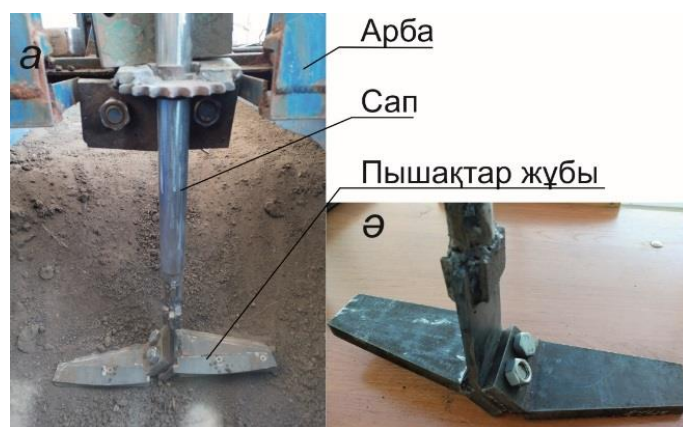
3.3-сурет. Кесу жиегінің бұрышы 27° пышақтар жинақталған арба (а), кескіш жиек жасалмаған пышақ (ә)
