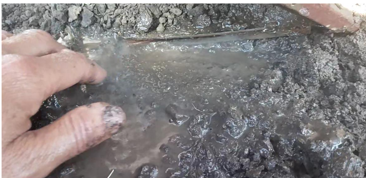
Ғ. 10-сурет. Пышақ және бүріккіштің жұмыс жағдайын, топырақты қазып тексеру (а, ә, б)
