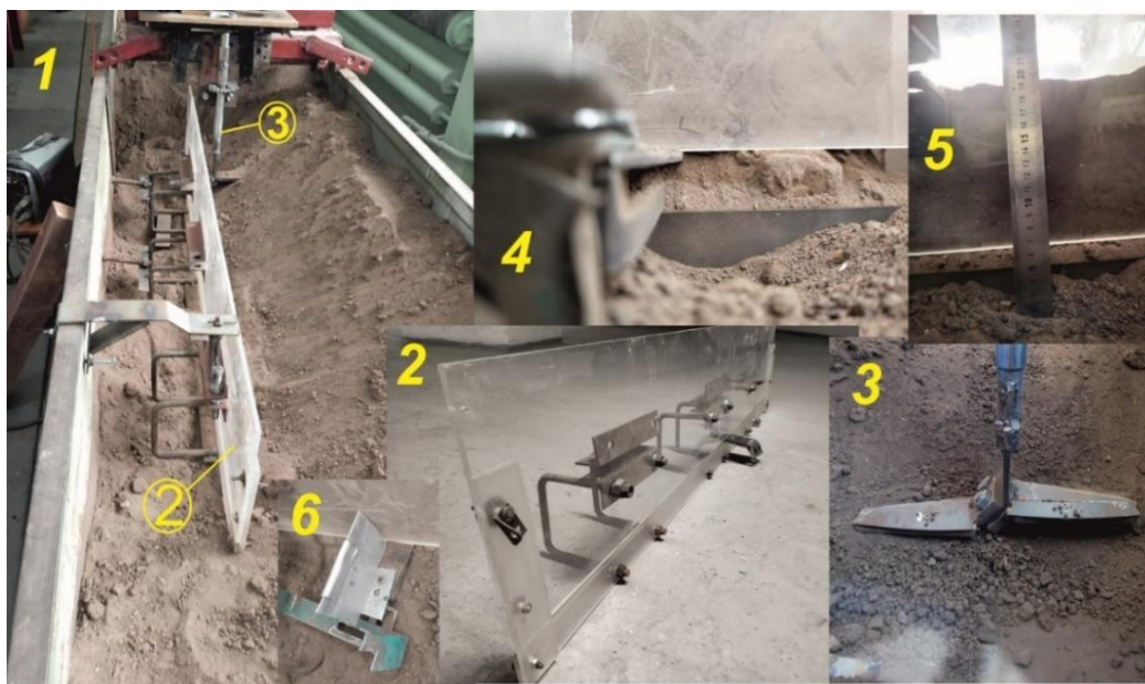
1. Топырақ арнасы. 2. Мөлдір экран. 3. Сапқа бекітілген пышақтар жұбы. 4. Пышақ. 5. Тереңдік өлшеу (сызғыш). 6. Кронштейн
