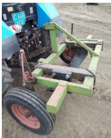
Ғ. 5-сурет. Эксперименталдық тереңқопсытқыш (а) СМТ-ны беру және тарату қондырғысы орнатылған күйі (ә)
