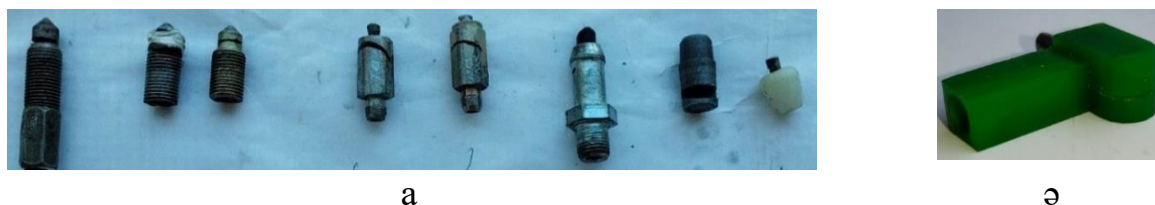
3.10-сурет. Техникада қолданыстағы саптамалардан өңделіп жасалған алғашқы саптамалар (а) көлденең сызатты модель (ә)
