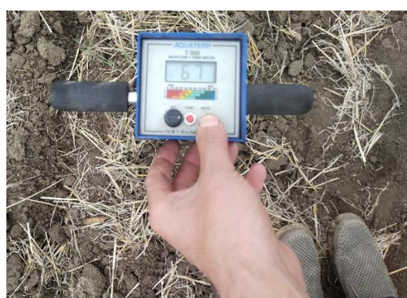
а – қажетті тереңдікті өлшеу және оның профилі; ә, б – топырақтың тығыздығын өлшеу; в – топырақтың ылғалдылығы мен температурасын өлшеу
