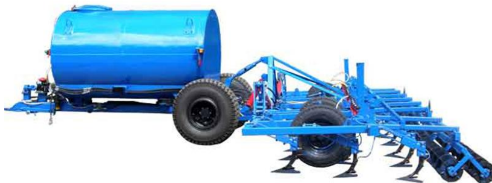
1.7-сурет. АВА-8 аммиак суын енгізуге арналған агрегат [58]
